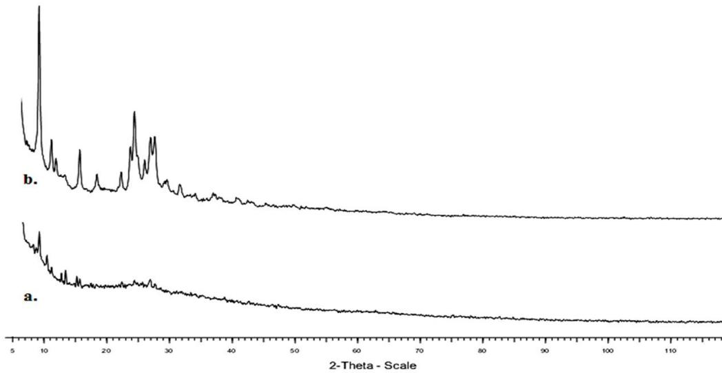
Fig. 2. a). XRD of  $\beta$ -cyclodextrin, b). XRD of *Citrus limonium*- $\beta$ -cyclodextrin composite
